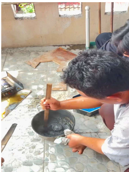
Gambar 3. Praktek Pembuatan Paving Block Berbahan Limbah Plastik Sumber: Dokumentasi Pribadi
